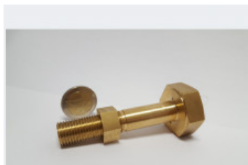
Bild 1: Prototyp der Sensorschraube im Größenvergleich. (Bild: TU Chemnitz)
